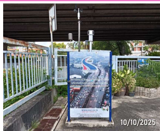
รูปที่ 3.2-19 ระบบเฝ้าระวังคุณภาพสิ่งแวดล้อม แบบ Online Real-Time (บริเวณด่านเก็บค่าผ่านทางพิเศษรามอินทรา)
